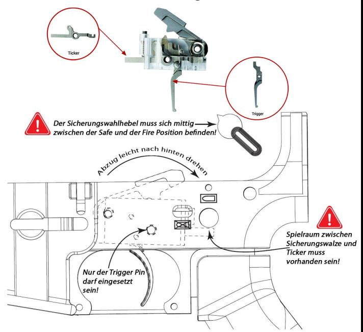
**4a)** Damit Die Sicherungswalze leicht, und ohne den Ticker zu berühren, eingeführt werden kann, muss sich der Sicherungswahlhebel Mittig zwischen der SAFE und der FIRE Position befinden! Danach drehen Sie den Abzug am Hammer oben, leicht nach hinten, es darf sich nur der Trigger Pin im Gehäuse befinden! Führen Sie erst jetzt die Sicherungswalze ein!
