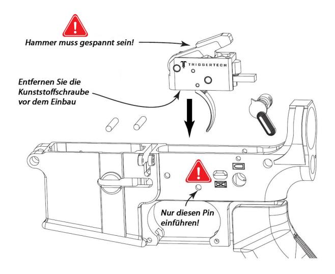
WARNUNG: Seien Sie vorsichtig, wenn Sie die Kunststoffschraube entfernen, welche die Transportsicherung ist, da sich der Abzugshammer schnell lösen kann. Üben Sie keinesfalls Druck auf das Abzugszüngel oder auf den Ticker aus solange die Abzugseinheit nicht fertig verbaut wurde, dies kann zu einer Beschädigung der Abzugseinheit führen!
