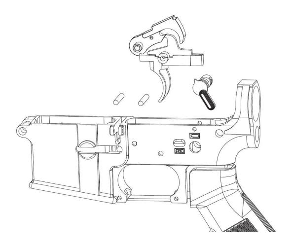
**2a)** Spannen Sie zuerst den Hammer, danach lockern Sie die Schraube im Pistolengriff langsam und ziehen Sie diesen nur so lange weit nach unten bis der Pin für die Sicherungswalze nicht mehr in diese eingreift, erst danach entfernen Sie die Sicherung. Bei manchen Gehäuseunterteilen (Lower Receiver) muss der Pistolengriff hierzu vollständig entfernt werden.
