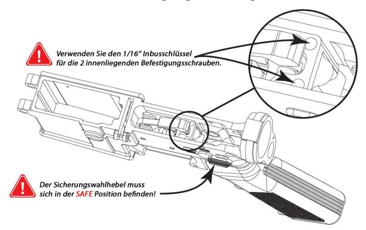
WARNUNG: Der Sicherungswahlhebel muss sich während dem Festziehen der beiden Befestigungsschrauben in der SAFE Position befinden! Andere Winkel können den Abzug beschädigen, somit erlischt die Gewährleistung von TriggerTech!
