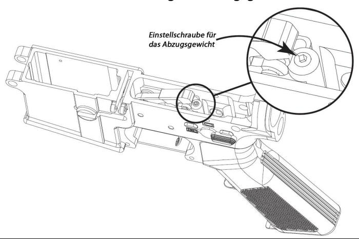
HINWEIS: Bei vielen TriggerTech-Modellen ist eine Justage des Abzugsgewichtes möglich. Die Einstellschraube befindet sich in der Mitte hinten am Abzug. Das Abzugsgewicht ist bereits ab Werk voreingestellt und befindet sich im mittleren Bereich der angegeben Leistungsdaten des jeweiligen Modells.
